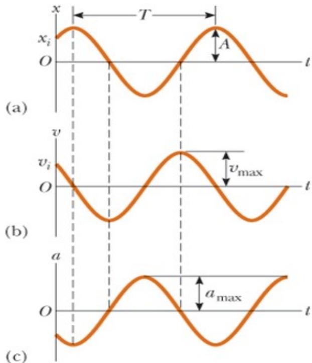
Fase della velocità differisce di  $90^\circ$  rispetto alla posizione. Per  $x_{\max}$ ,  $v$  è nullo. Per  $x=0$ ,  $|v|=\max$
