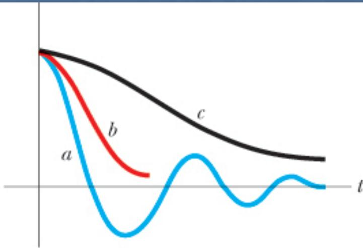
**Figura 15.22** Il grafico dello spostamento in funzione del tempo per un oscillatore debolmente smorzato (curva *a*, blu), un oscillatore soggetto a smorzamento critico (curva *b*, rossa) e un oscillatore fortemente smorzato (curva *c*, nera).
