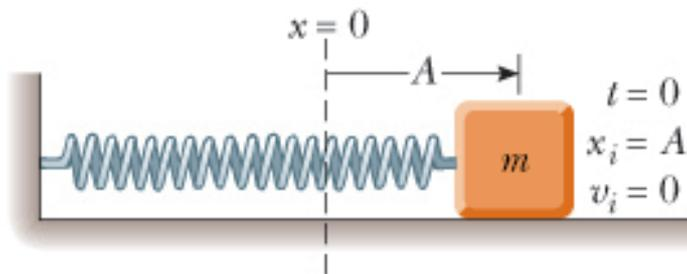
**Figura 15.6** Un sistema massa-molla che inizia il suo moto dalla posizione  $x = A$ , dove si trova in quiete, a  $t = 0$ . In questo caso,  $\phi = 0$  e, di conseguenza,  $x = A \cos \omega t$ .
