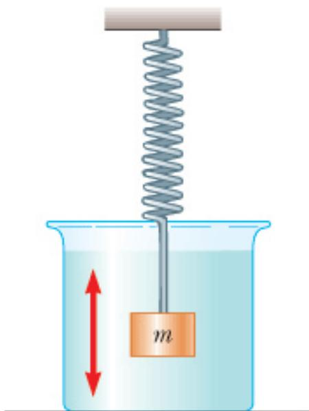
**Figura 15.20** Una massa appesa ad una molla ed immersa in un liquido viscoso è un esempio di oscillatore smorzato.
