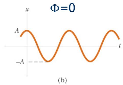
**Figura 15.2** (a) Un grafico  $x-t$  per una massa che segue un moto armonico. L'ampiezza del moto è  $A$ , il periodo (definito nell'Eq. 15.10) è  $T$ . (b) Il grafico  $x-t$  nel caso particolare in cui, per  $x = A$   $t = 0$ , e quindi  $\phi = 0$ .
