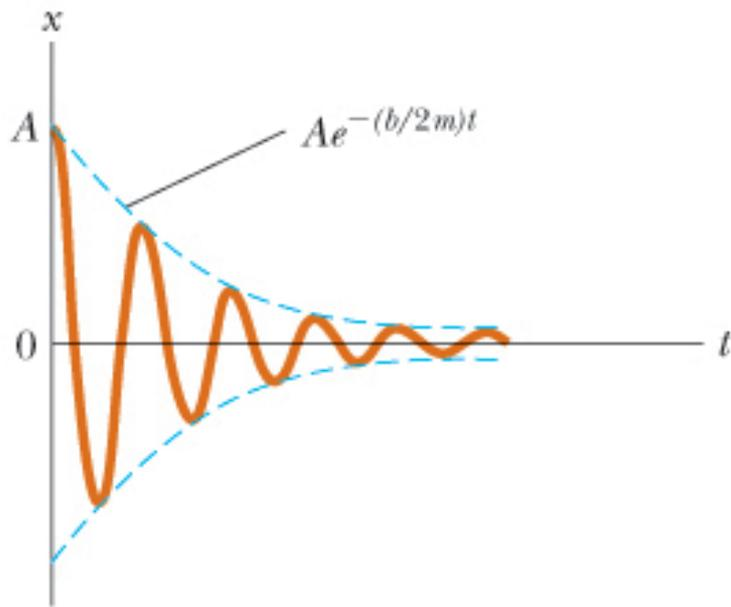
**Figura 15.21** Il grafico dello spostamento in funzione del tempo per un oscillatore smorzato. Si noti la diminuzione dell'ampiezza nel tempo.
