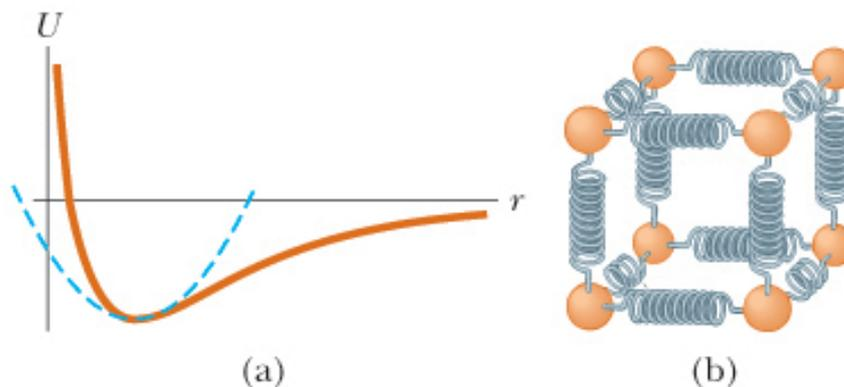
**Figura 15.11** (a) Se lo spostamento degli atomi di una molecola dalla loro posizione di equilibrio è piccolo, in un intorno centrato nella posizione di equilibrio il grafico dell'energia potenziale in funzione della separazione fra gli atomi è simile a quello dell'energia potenziale di un oscillatore armonico. (b) La forza che tiene insieme gli atomi si può schematizzare come quella prodotta da un sistema di molle che collegano gli atomi vicini.
