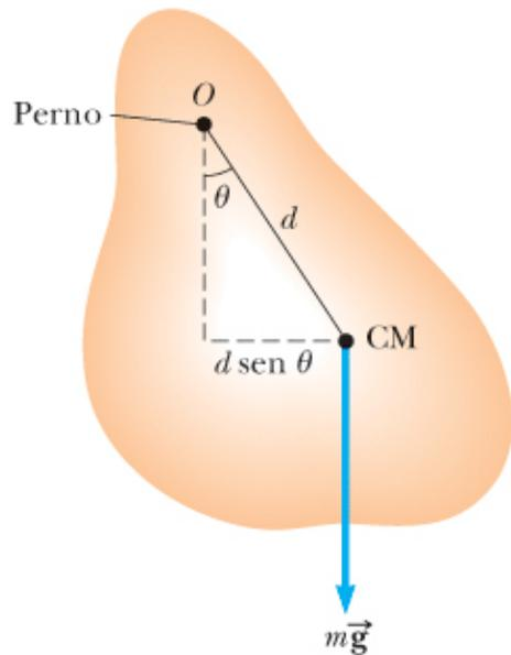
**Figura 15.17** Un pendolo fisico incernierato in  $O$ .
