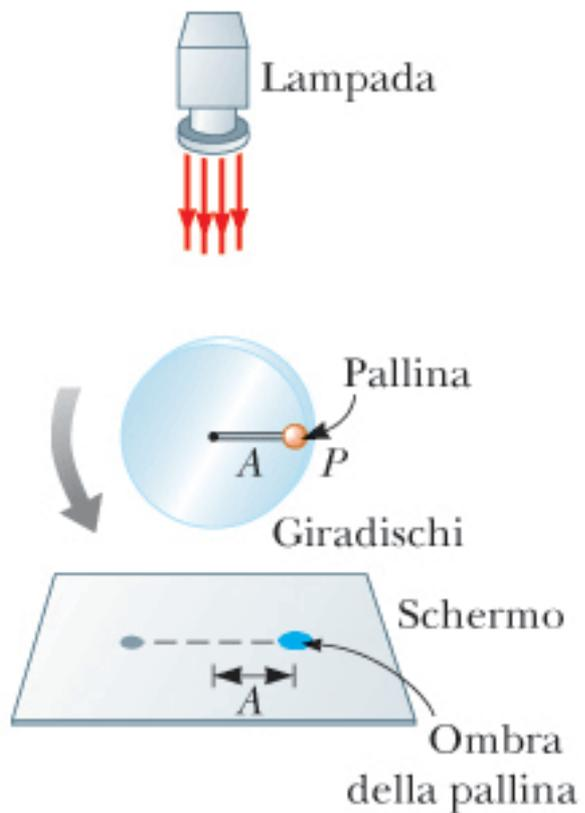
**Figura 15.13** Un apparato sperimentale per mostrare la connessione fra il moto di un oscillatore armonico ed il moto circolare. L'ombra di una palla in moto circolare uniforme, proiettato su uno schermo, segue un moto armonico.
