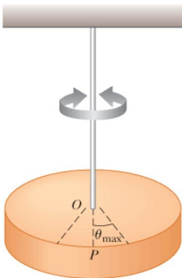
**Figura 15.19** Un pendolo di torsione è formato da un corpo rigido sospeso ad un filo attaccato ad un supporto rigido. Il corpo oscilla intorno alla linea  $OP$  con un'ampiezza  $\theta_{\max}$ .
