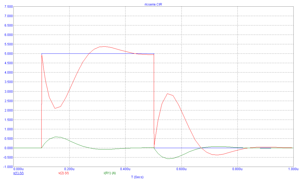
Figura 1.28: Risultato dell'analisi Transient del circuito di Fig. 1.26 con induttanza pari a 200nH .
