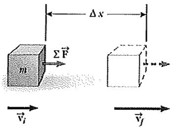
**FIGURA 6.11** Un oggetto assimilato a una particella che subisce uno spostamento di modulo  $\Delta x$  e una variazione di velocità sotto l'azione di una forza risultante costante  $\Sigma \vec{F}$ .
