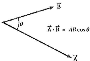
**FIGURA 6.6** Il prodotto scalare  $\vec{A} \cdot \vec{B}$  è uguale al modulo di  $\vec{A}$  moltiplicato per il modulo di  $\vec{B}$  ed il coseno dell'angolo tra  $\vec{A}$  e  $\vec{B}$ .
