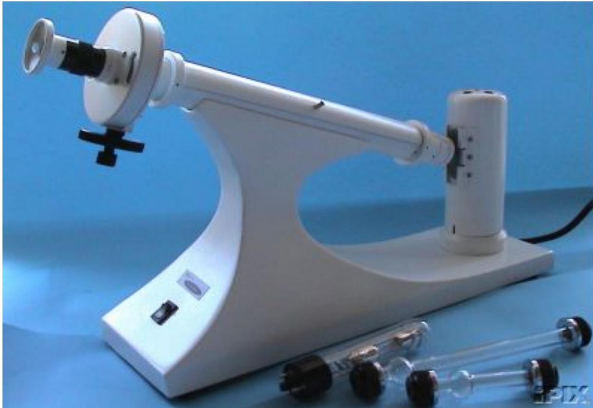
La luce, prodotta da una sorgente costituita da una lampada ai vapori di sodio, si propagherà su infiniti piani di vibrazione lungo la direzione di propagazione (teoria ondulatoria).
