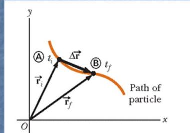
**FIGURA 3.1** Una particella che si muove nel piano  $xy$  è localizzata dal vettore posizione  $\vec{r}$  tracciato dall'origine alla particella. Lo spostamento della particella allorché essa si muove da  $\textcircled{A}$  a  $\textcircled{B}$  nell'intervallo di tempo  $\Delta t = t_f - t_i$  è uguale al vettore  $\Delta \vec{r} \equiv \vec{r}_f - \vec{r}_i$ .
