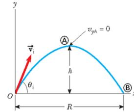
**FIGURA 3.7** Un proiettile lanciato dall'origine con velocità iniziale  $\vec{v}_i$  al tempo  $t = 0$ . La massima altezza del proiettile è  $h$  e la sua gittata è  $R$ . In  $\textcircled{A}$ , il punto più alto della traiettoria, il proiettile ha  $(R/2, h)$ .
