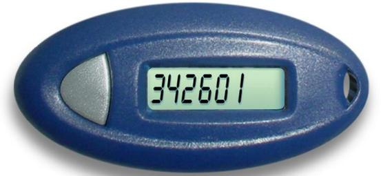
Il **token** è un dispositivo elettronico portatile in grado di generare un codice di sicurezza in base ad un algoritmo che talvolta tiene conto del «momento» in cui viene utilizzato.
