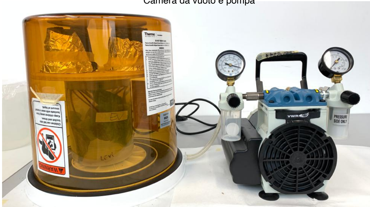
Camera da vuoto e pompa
