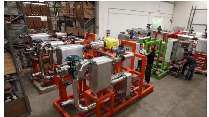
I moduli ORC Zuccato Energia possono in generale sfruttare **qualsiasi fonte di calore**, con temperature a partire da 85° C.
