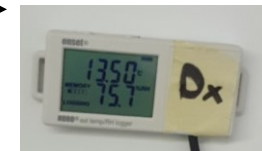
Sensore per monitorare le condizioni reali nella camera
